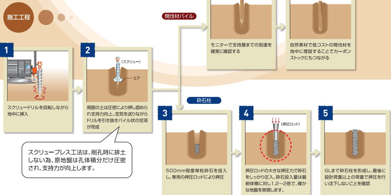
スクリープレス工法は、削孔時に排土しない為、原地盤は孔体積分だけ圧密され、支持力が向上します。
